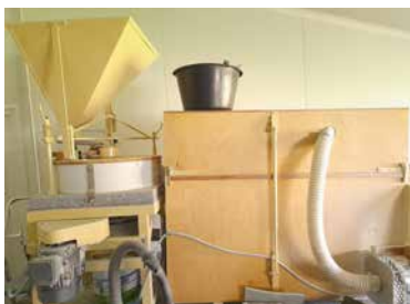
Moulin sur meule de pierre de type « Astrié » de 50 cm de diamètre, avec une trémie surmontant le moulin et la bluterie à droite
