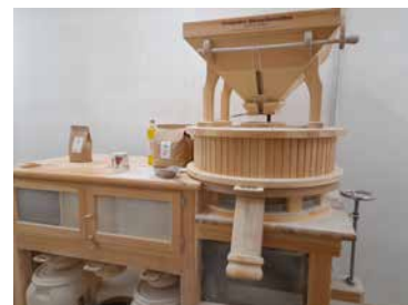
Moulin à farine de type 'du Tyrol'
