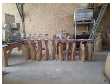
Ligne d'ensachage en sac de 25 kg à la sortie du moulin
