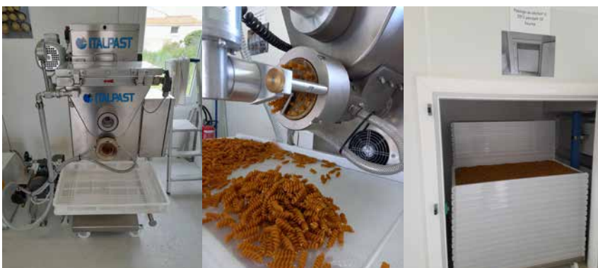
Extrudeuse ou presse à pâtes sur les deux photos de gauche, séchoir à pâtes sur la photo de droite
