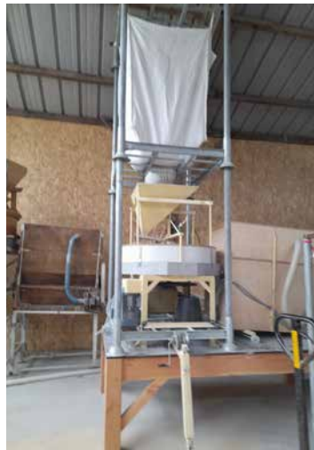
Moulin de type 'Astrié' de taille de meule de 100 cm, avec une structure accueillant un big-bag comme trémie pour le grain
