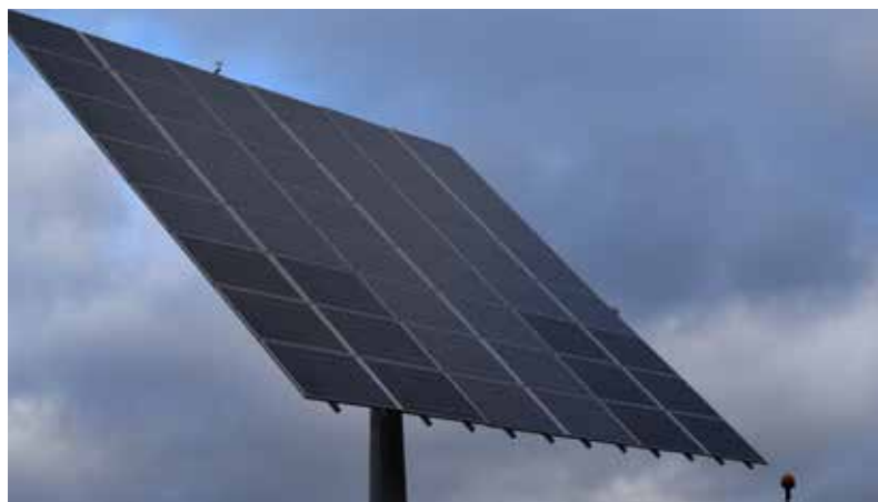
Le tracker photovoltaïque suit au plus près la course du soleil pour une production optimale des panneaux.
