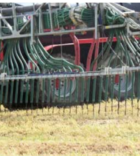
Le pendillard qui dépose le lisier au sol réduit de 30 à 50 % la volatilisation de l'azote ammoniacal
