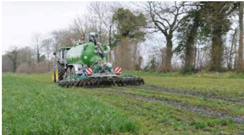
L'enfouisseur à disques sur 6 m de large
