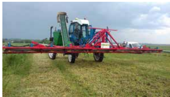
Ecimeuse de l'entreprise Giffard, outil utilisé après épiaison des céréales pour limiter la prolifération des graminées et vivaces.
