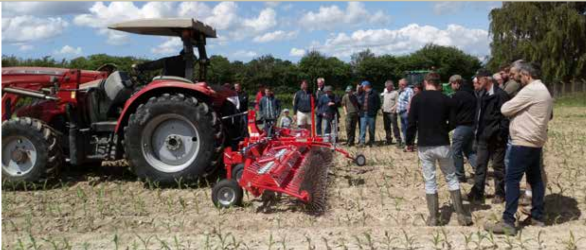
Roto étrille de la CUMA des Salers qui permet d'assurer un désherbage mécanique sur le rang.
