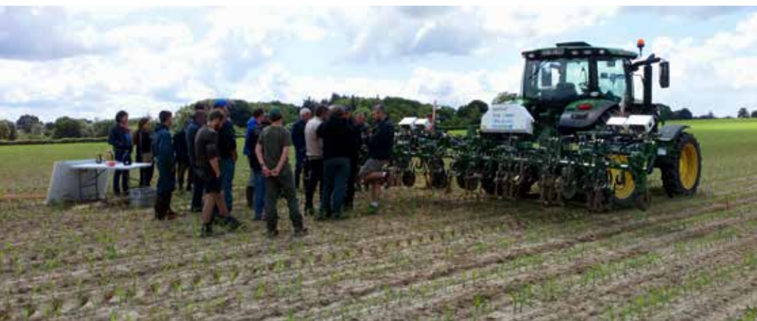
Bineuse Garford de la CUMA des Vallons du Douet permettant de biner 4 ou 8 rangs.
