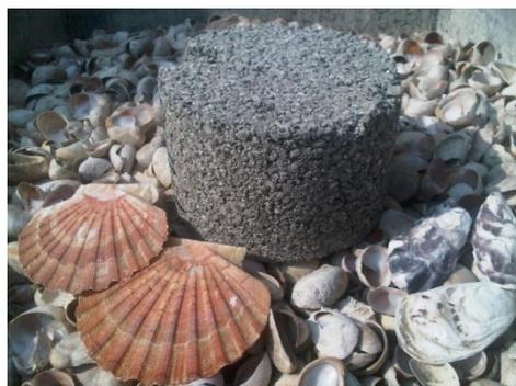
Développé par le laboratoire de recherche de l'ESITC Caen (école supérieure des travaux de la construction) l'éco-pavé drainant à base de coquillages est une innovation qui marquera les travaux publics de demain.
